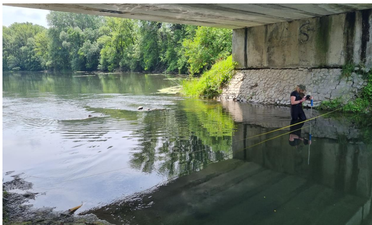
Obr. 30. Meranie prietoku a hladiny v Klátovskom ramene pod mostom v Trhovej Hradskej (cca rkm 6,450).
