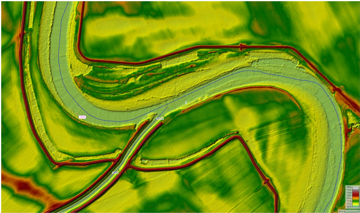
Obr. 6. Zameranie morfológie metódou LIDAR (bez možnosti mapovania dna). Oblasť sútoku Klátovské rameno - kanál Gabčíkovo-Topoľníky, ZBGIS 2024.
