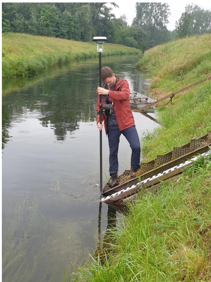
Obr. 33. Meranie hladiny v kanále SVII (Gabčíkovo – Topoľníky) v mernom profile SHMÚ pred zaústením do Klátovského ramena v Topoľníkoch.
