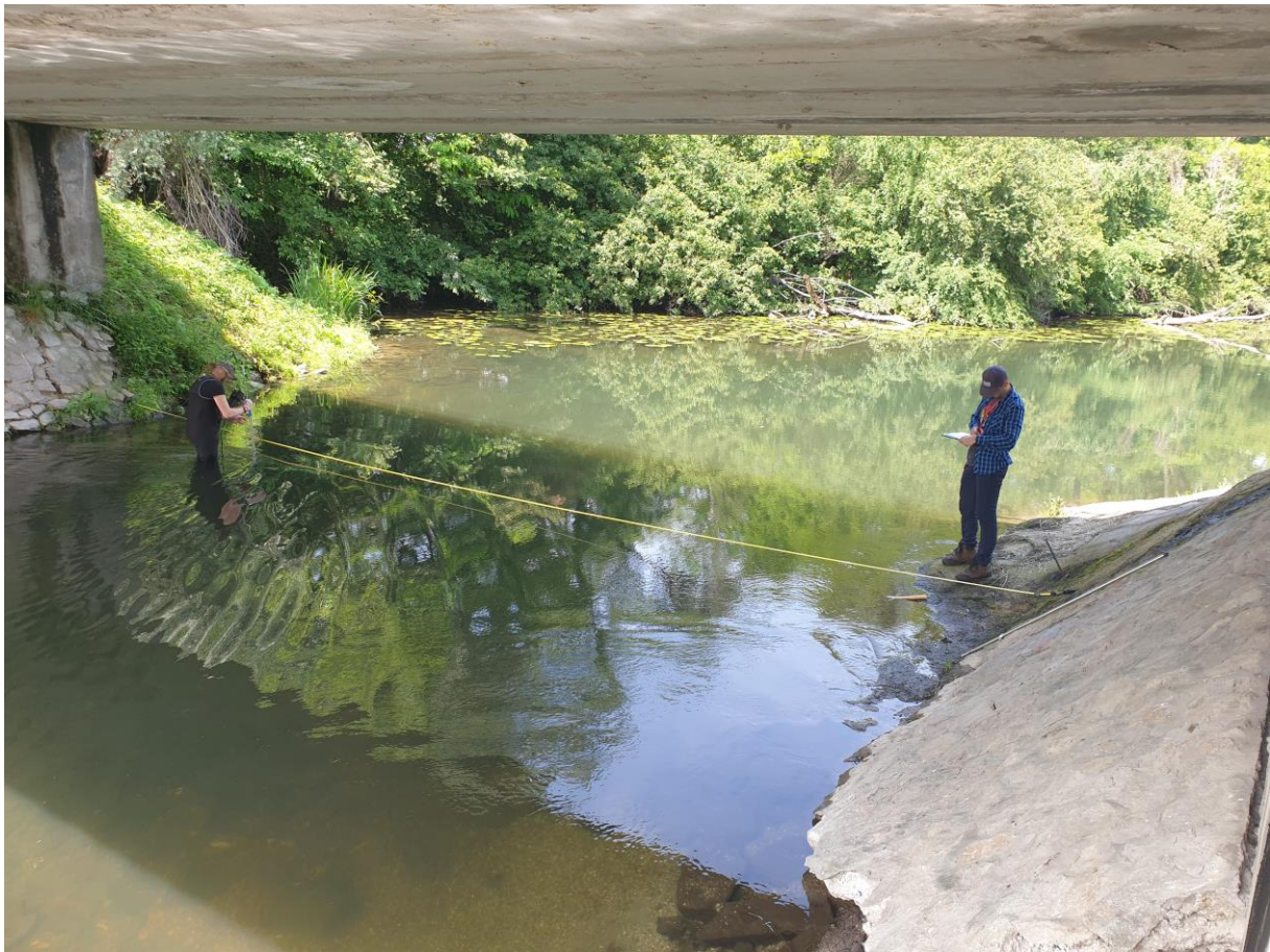
Obr. 31. Meranie prietoku a hladiny v Klátovskom ramene pod mostom pri Hornom Mýte (cca rkm 9,750).
