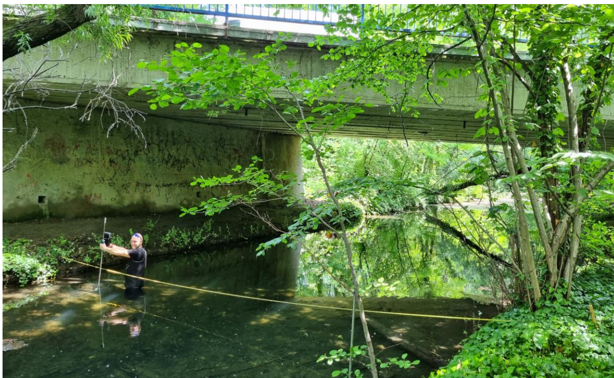
Obr. 29. Meranie prietoku a hladiny v Klátovskom ramene pod mostom v Dunajskom Klátove (cca rkm 15,450).
