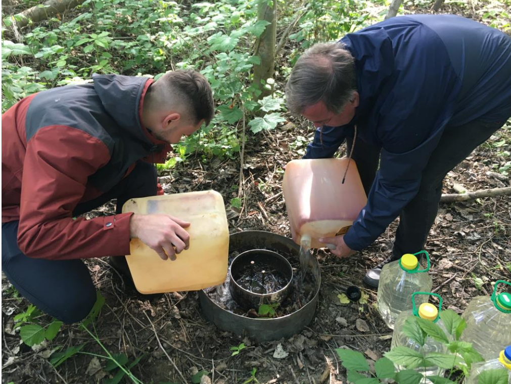
Obr.10. Nalievanie vody do vsakovacích valcov za účelom stanovenia rýchlosti vsakovania vody do pôdy (foto doc. Baroková).
