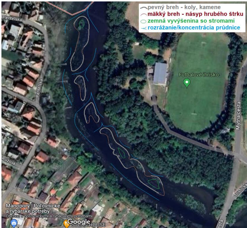
Obr.80. Návrh sústavy ostrovov na numerické testovanie.
