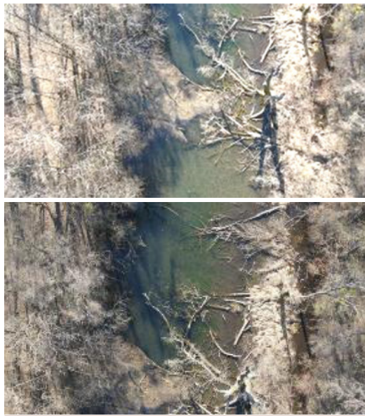
Obr. 5.60 Popadané stromy v úseku výrazne menia prietoknosť a tvoria plytčiny
