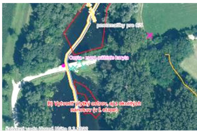
Obr. 6.12 Návrh riešenia pre presun sedimentov v koryte a vytvorenia štrkových lavíc
