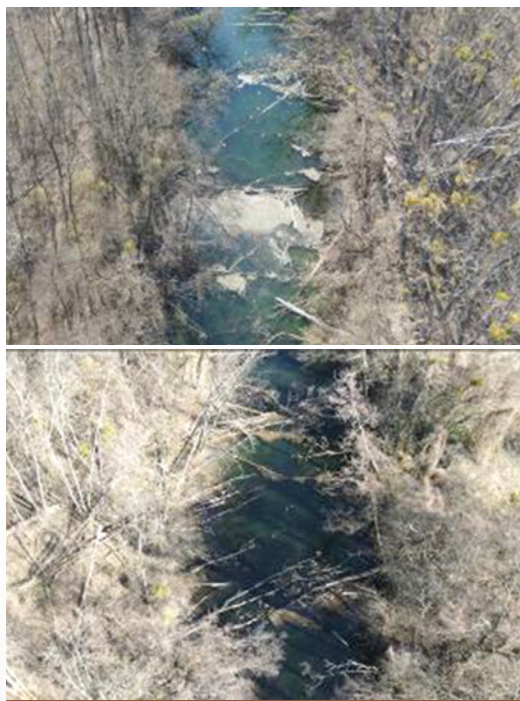
Obr. 5.58 Popadané stromy v úseku výrazne menia prítoknosť
