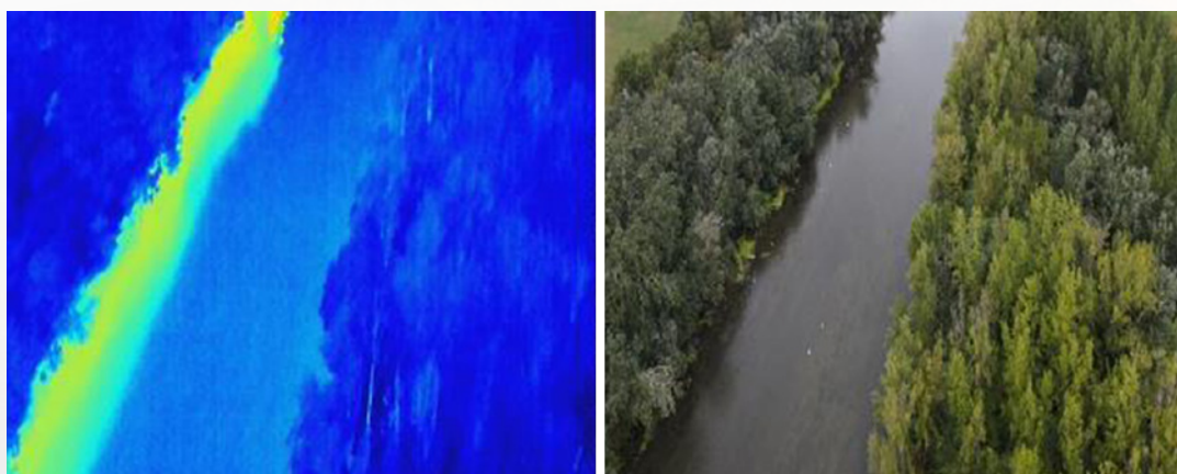
Obr. 5.121 Letecká a termálna snímka odtoku vody z Termálneho kúpaliska Topoľníky
