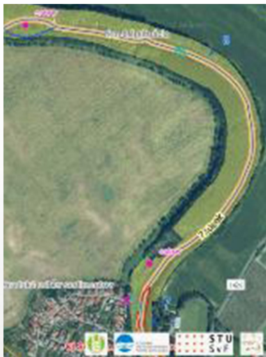
Obr. 6.8 Návrh riešenia pre presun sedimentov v koryte a vytvorenia štrkových lavíc
