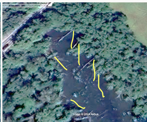
Obr. 6.19 Stav koryta pod mostom v Dunajskom Klátove a potreba presunu stromov
