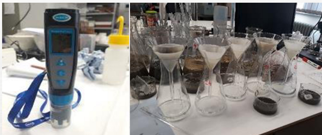
Obr. 6.38 Výluhy a meranie parametrov pomocou ručného testera (Landczman, 2023)
