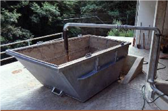
Obr. 6.63 Návrh riešenia na mobilné odvodnenie sedimentov a organickej hmoty
