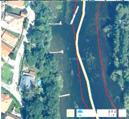
Obr. 6.8 Návrh riešenia pre presun sedimentov v koryte a vytvorenia štrkových lavíc
