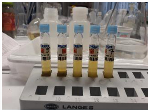
Obr. 6.39 Skúmavky s čínilom pomiešaným so vzorkou vody (Landczman, 2023)
