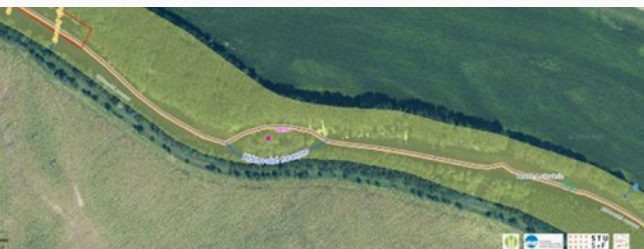
Obr. 6.10 Návrh riešenia pre presun sedimentov v koryte k jestvujúcemu ostrovčeka v koryte
